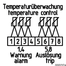
Obr. 3: Příklad přiřazení svorek při standardním provedení hlídní teploty
