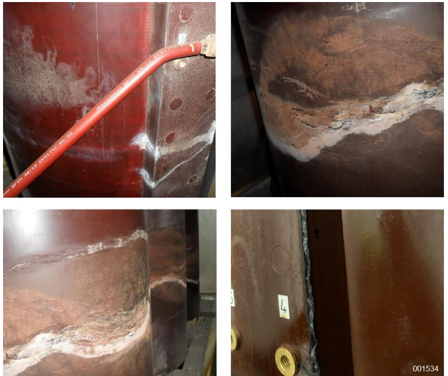
Abb. 24: Kriechspuren und Teilentladungsspuren
